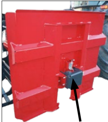
Massiver klappbarer Spalttisch ohne Stützfüsse. Sicherheitsverriegelung für Strassentransport. (Nicht bei FW Spalter)
