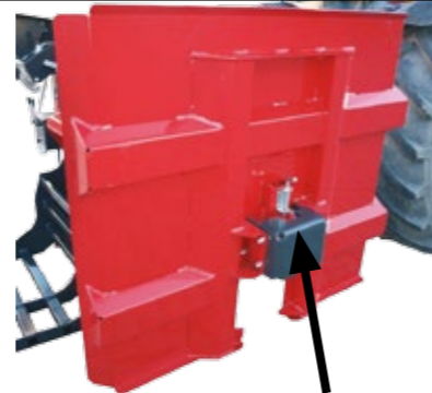
Massiver klappbarer Spalttisch ohne Stützfüsse. Sicherheitsverriegelung für Strassentransport.
