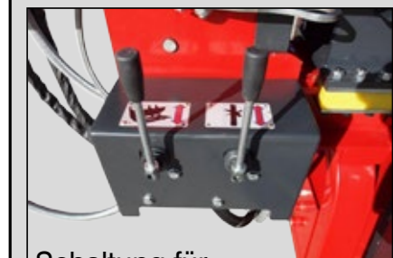
Schaltung für Hubgerät und Spaltwerkzeugverstellung
