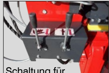
Schaltung für Hubgerät und Spaltwerkzeugverstellung
