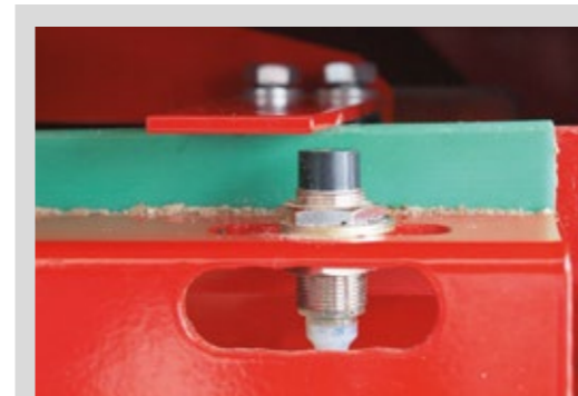
Kontaktlose Spaltersteuerung Verschleißfreier Betrieb
