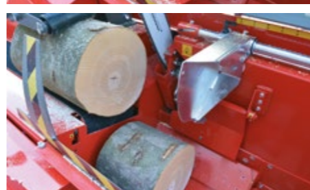
„Landing Plates“ für den optimalen Fall des Holzes können bei Bedarf zugeschaltet werden. Serie
