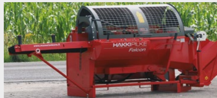
Einteilige Sicherheitsschutzhaube mit integriertem Not-Stopp (ab Modellreihe 2011)
