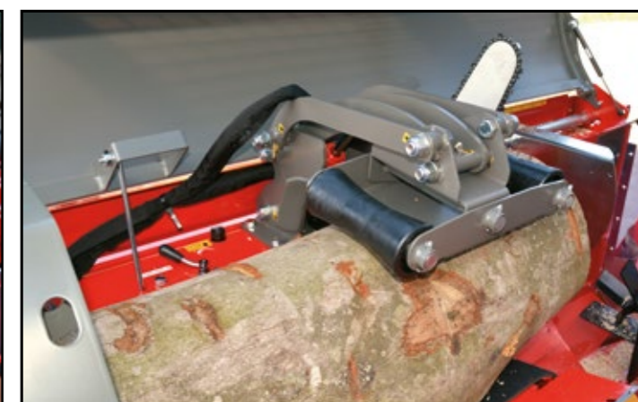
Hydraulischer Niederhalter in Boogietechnik zum sicheren Fixieren des Holzes
