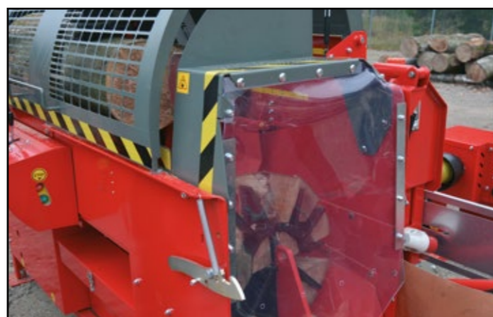
Sicherheit ohne Nachteil Vorhang zum Schutz gegen herausschleudernde Scheite
