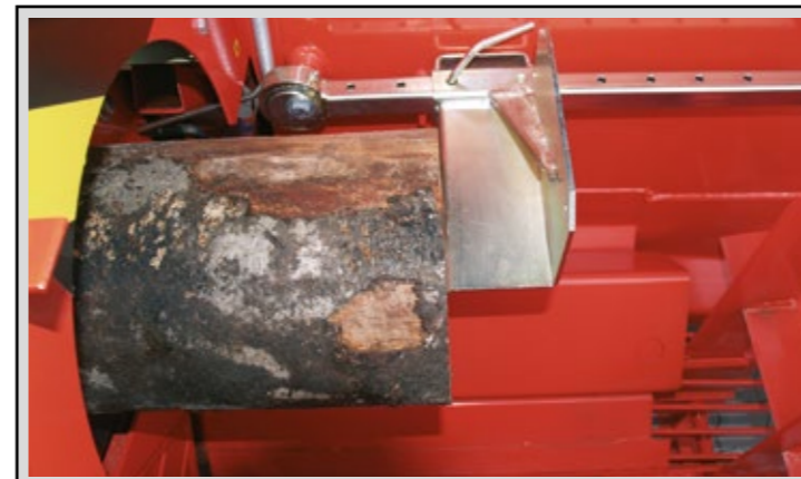
Stabiler und genau einstellbarer, beidseitig verwendbarer Längsanschlag für Spaltlängen bis 60 cm.
