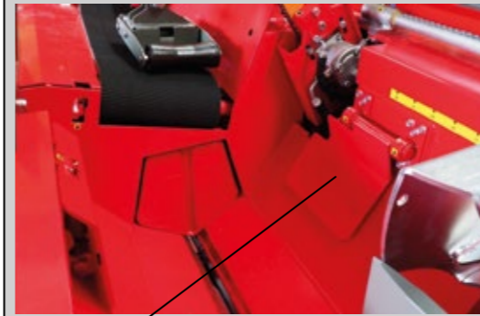
Landing Plates - zuschaltbar
