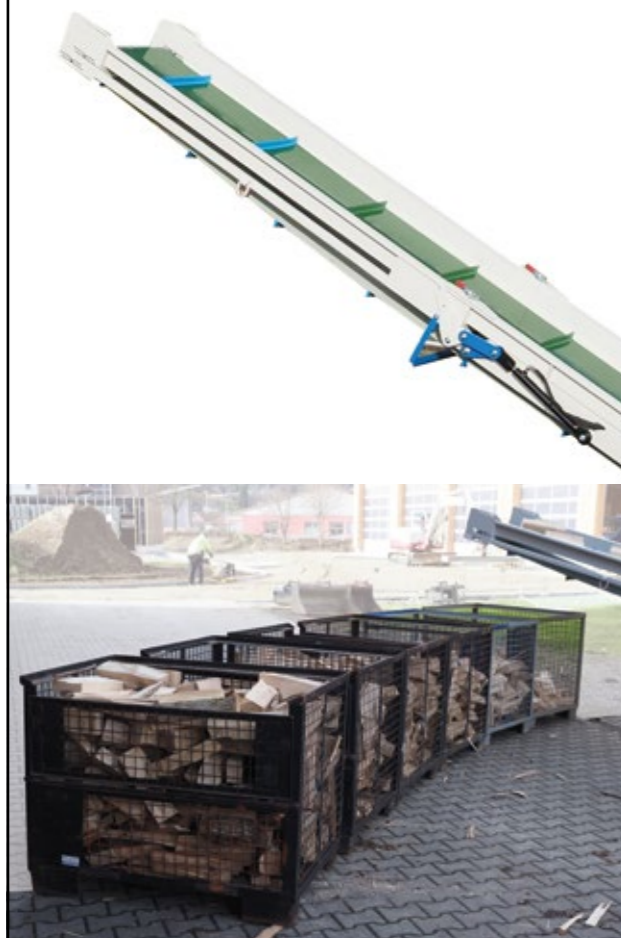
Das Förderband lässt sich in kürzester Zeit ohne Kraftaufwand hydraulisch aufklappen .
