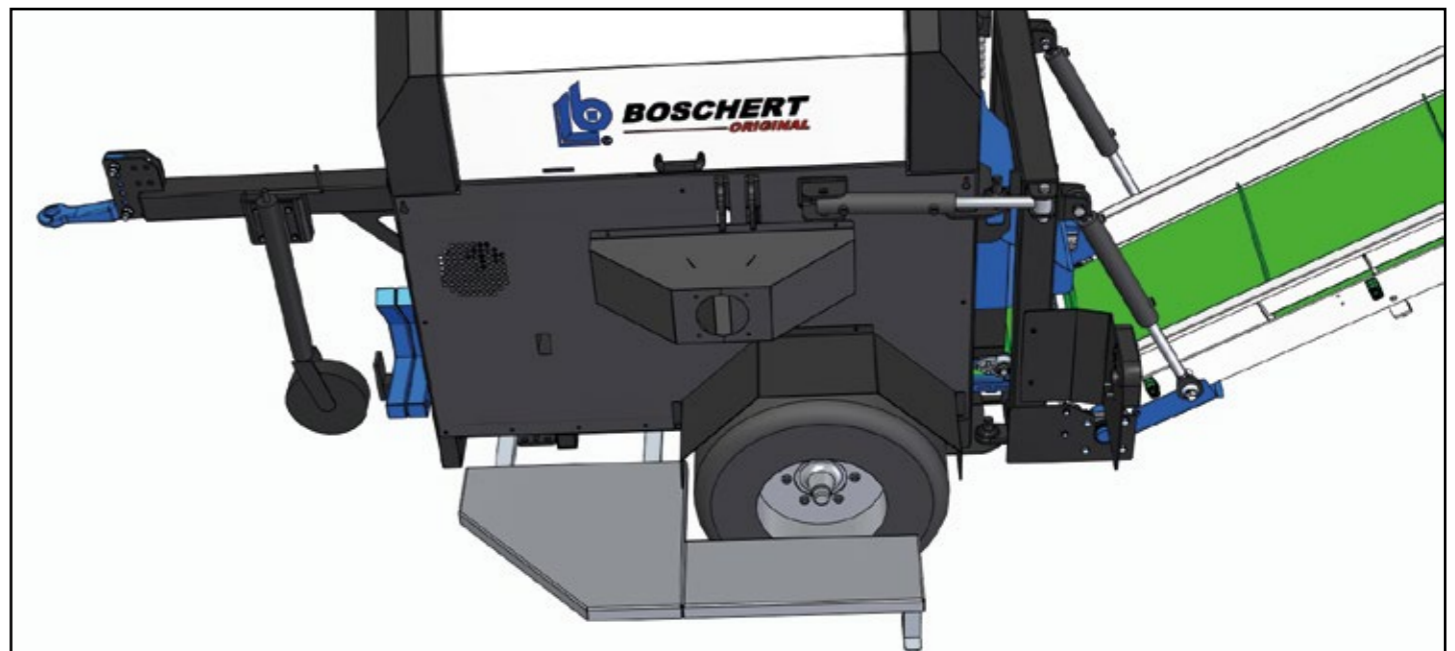
Als Komfort-Lösung bieten wir optional ein Podest an welches das Wechseln der Sägeblätter nochmals deutlich vereinfacht.
