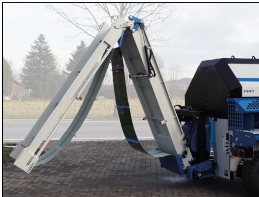
Das Förderband lässt sich in kürzester Zeit ohne Kraftaufwand hydraulisch aufklappen .
