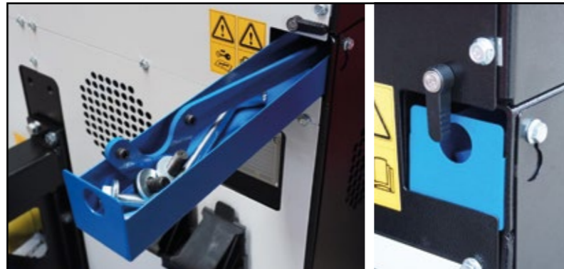
Werkzeugschublade inkl. Verriegelung Die nötigsten Werkzeuge immer am Band
