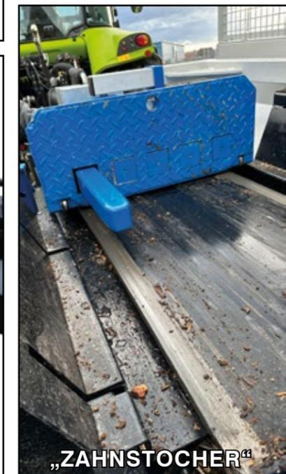
Mit dem sogenannten „Zahnstocher“ kann gegebenenfalls schnell und unproblematisch der Zwischenraum zwischen den Messern gereinigt werden.
