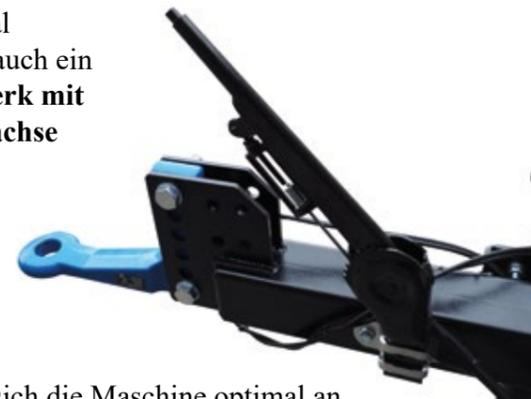
Damit sich die Maschine optimal an verschiedenste Anhängenhöhen anpassen lässt, kann die Zugöse in mehrere Höhen eingestellt werden.
