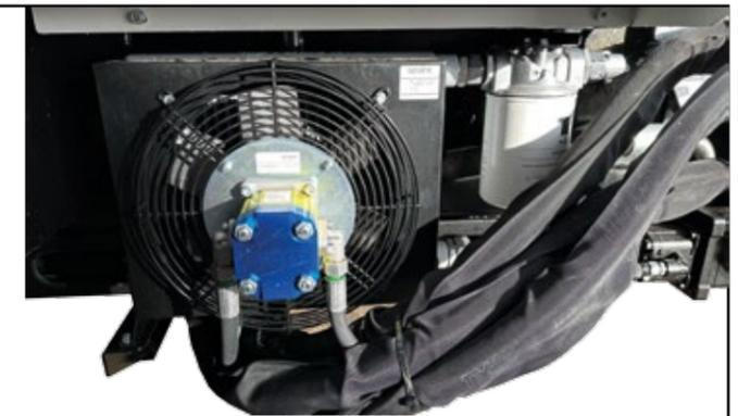
Das überdem schon großzügig ausgelegte Hydrauliksystem wird noch durch einen **Ölkühler** ergänzt.
