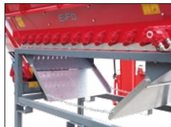
Auswurfschacht mit Verstellklappen
